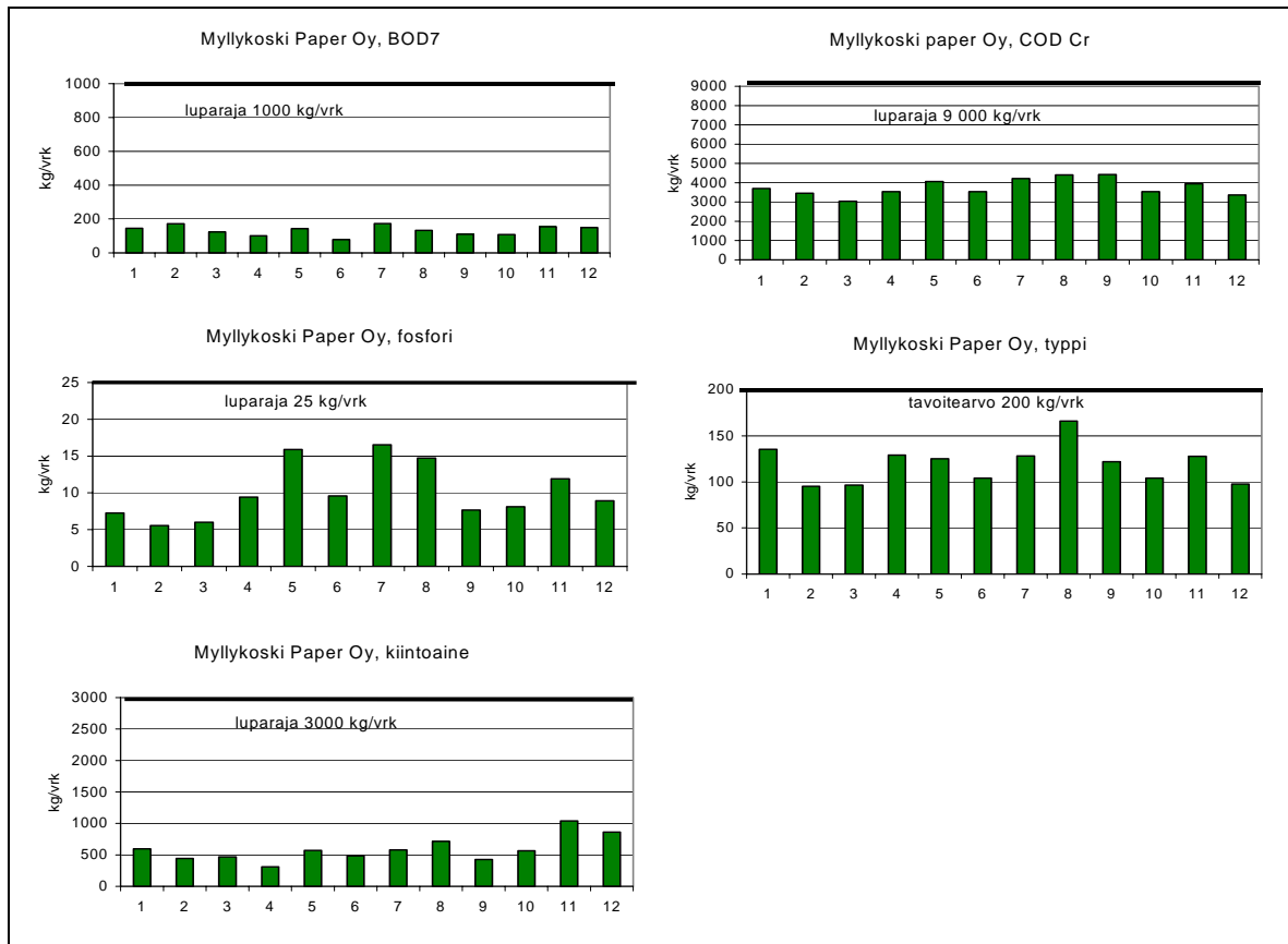
Kuva 5. Myllykoski Paper Oy:n BOD 7 -, COD Cr -, fosfori-, typpi- ja kiintoainekuormitus (kg/vrk) kuukausikeskiarvoina vuonna 2006. Kuvissa on esitetty myös vesistökuormituksen kuukausiluparajat. Typen osalta kyseessä on tavoitearvo. Lähde: KAS/VAHTI.
